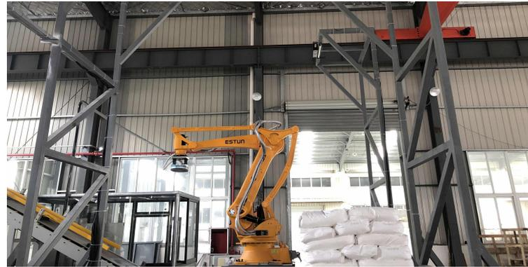
由于来料码放不规范、混料严重、节拍要求高、现场粉尘严重，以往此工位的原材料上料均采用人工上料，但由于人工拆垛成本高，效率低，且粉尘较大。
