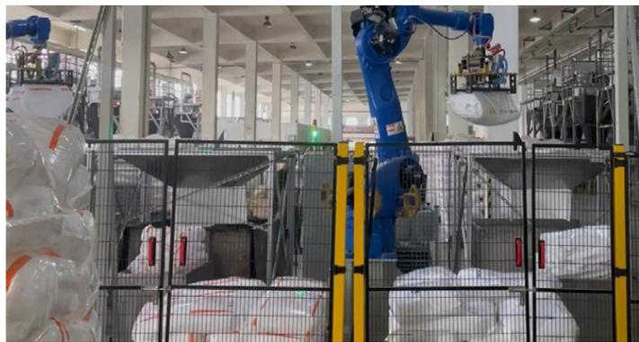
麻袋体积大且不规则，原有的人工搬运方式效率低，且传统方式无法有效识别。另工人难招，人工拆垛成本高。
