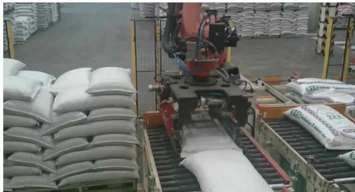
原来专机码垛，不具备柔性生产，无法应对各种多变的垛型，且码垛紧密型不足。来料的位置存在波动，导致抓取不够精确，从而导致垛型出现质量问题。
